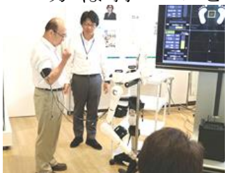
手の動きに合わせてロボットの関節が動く
