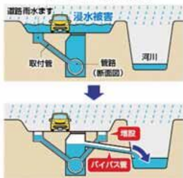
＜バイパス管の整備＞
