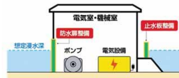
＜下水道施設の耐水化＞
