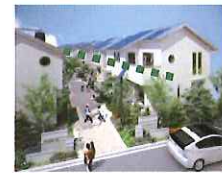
図3 例1 太陽光パネルを設置する前面の樹木は、中木を中心に植栽 例2 樹高7m以上になる高木を植える場合は、太陽光パネルの位置を考慮して配置・植栽等
