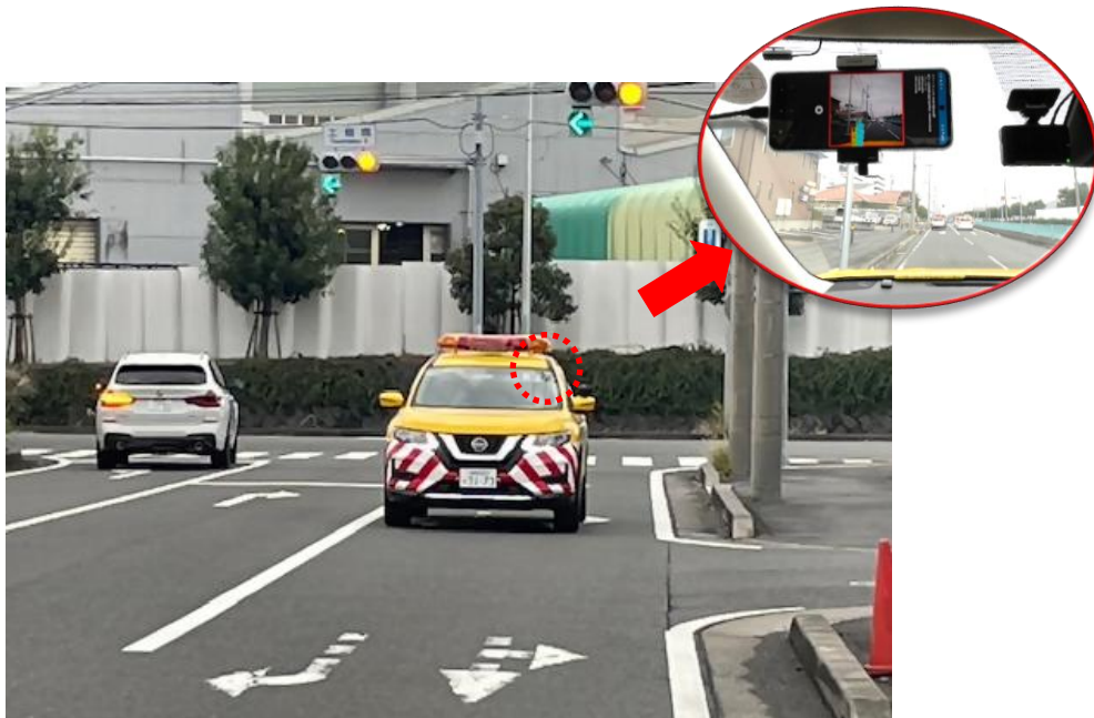
摩耗情報を撮影するスマートフォンを搭載して市内を走る道路パトロール車
